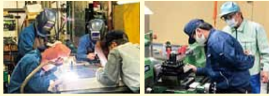
(指導の様子 左:電気溶接 右:普通旋盤)
